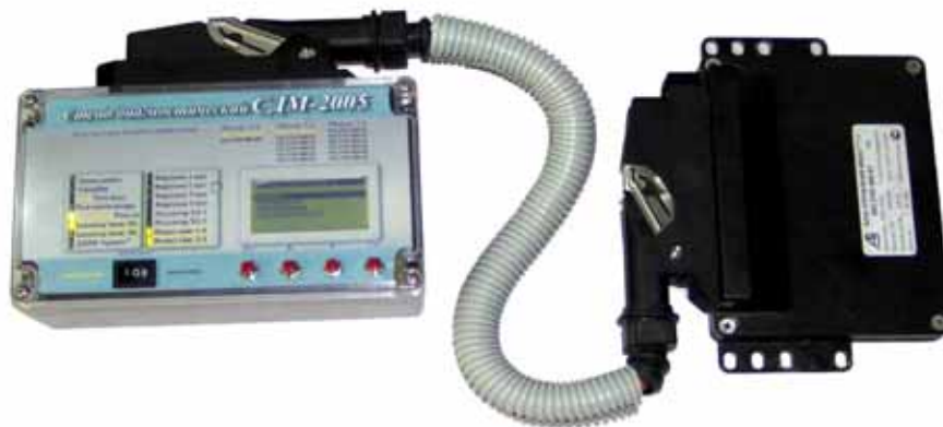
внешний вид диагностического тестера СДМ-2005
